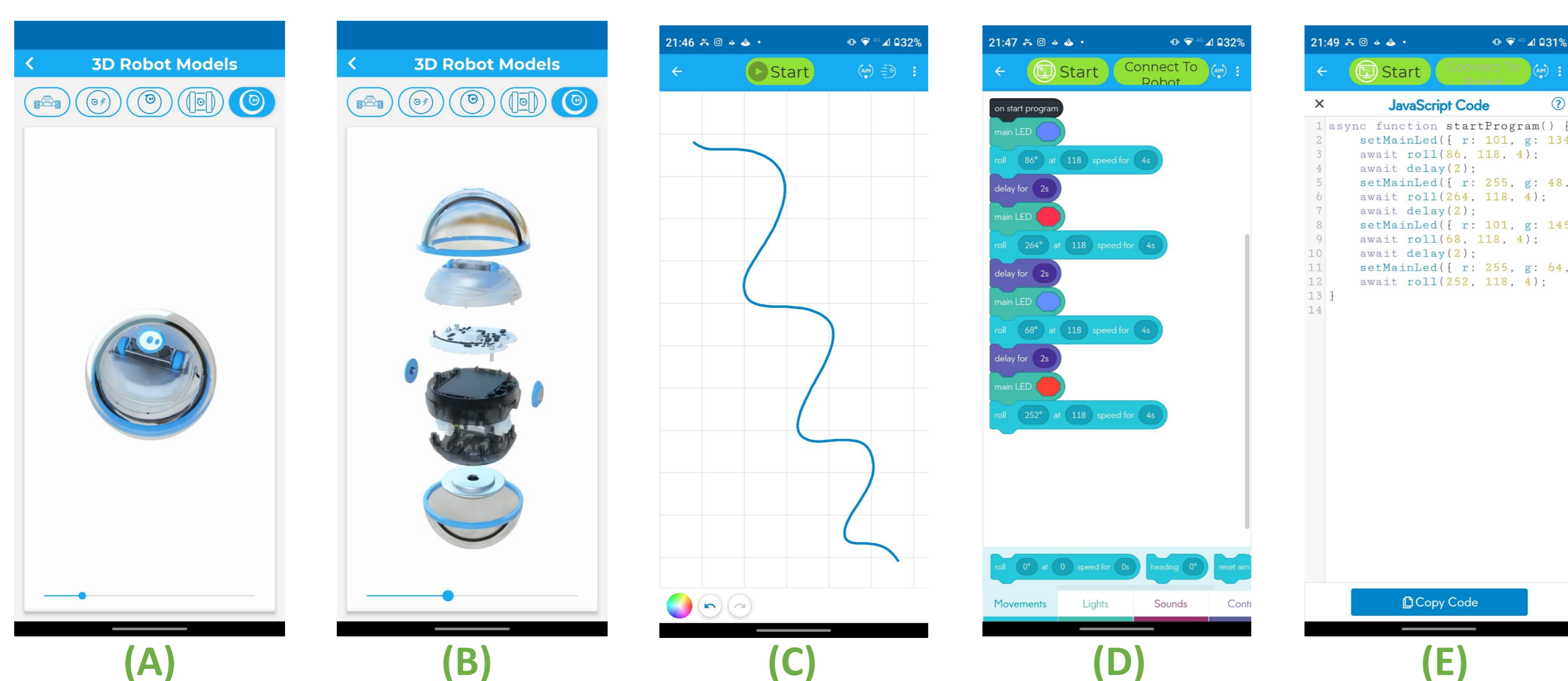
Figura 2: Telas do Sphero Edu com a Sphero Mini (A), suas partes internas (B), programação com desenho (C), programação com blocos (D) e programação com JavaScript (E).
